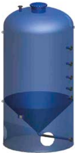
ZVp zbiornik pionowy na wydłużonym płaszczu z dolną dennicą stożkową
